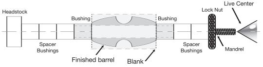
**DIAGRAM B • Turning the Blanks**
